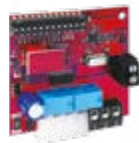
1x 5311L VIX 53/2 R radio ricevente 868,19 MHz da innesto
